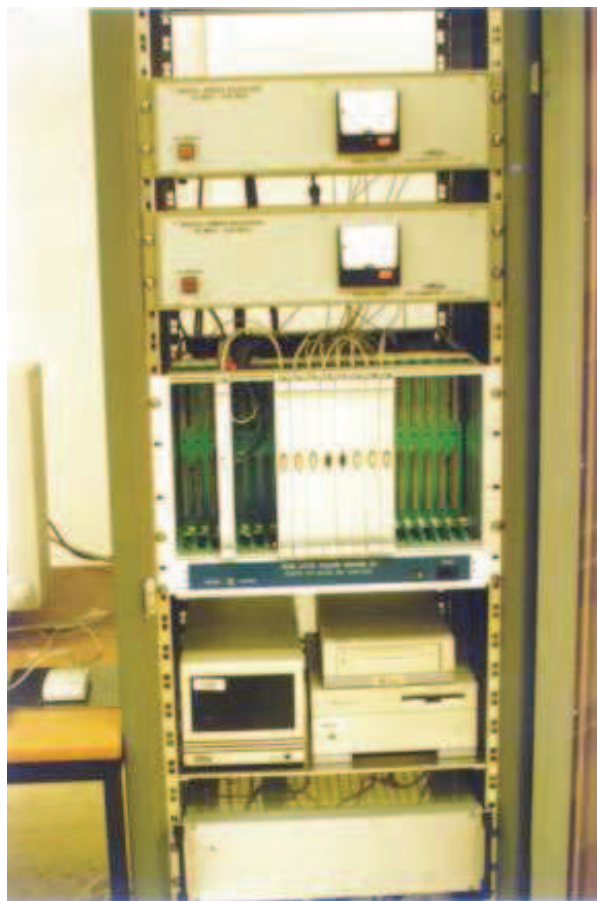
Rys. V.1: Terminal VLBI (u góry) i maszyna pulsarowa PSPM II (u dołu)
