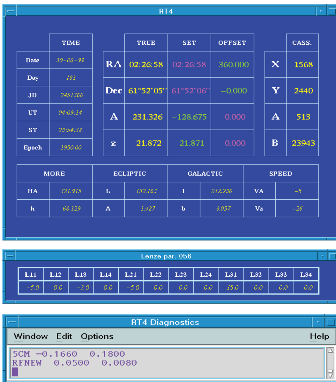
Rys. III.1: Okna monitorujące: RT4 zawierające czas, rzeczywiste i zadane współrzędne radioteleskopu oraz lustro Cassegraina (u góry), parametry napędów Lenze (w środku) oraz diagnostyka niektórych urządzeń (u dołu)
